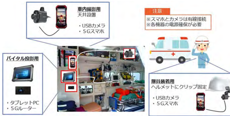
図表 3-4 送信機側（救急隊）カメラ設置状況
